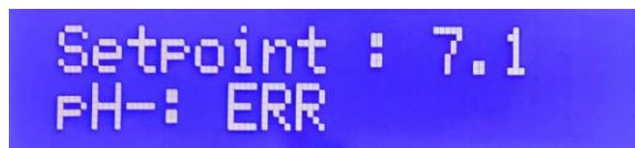
Figure 7 - Menu de démarrage avec erreur de sonde
