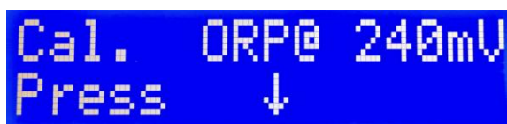
Figura 12 – Inserir a sonda de ORP no padrão 240mV
