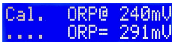
Figura 13 – Calibração de ORP padrão 240mV
