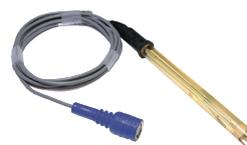
Figura 5 – Sonda de pH y ORP
