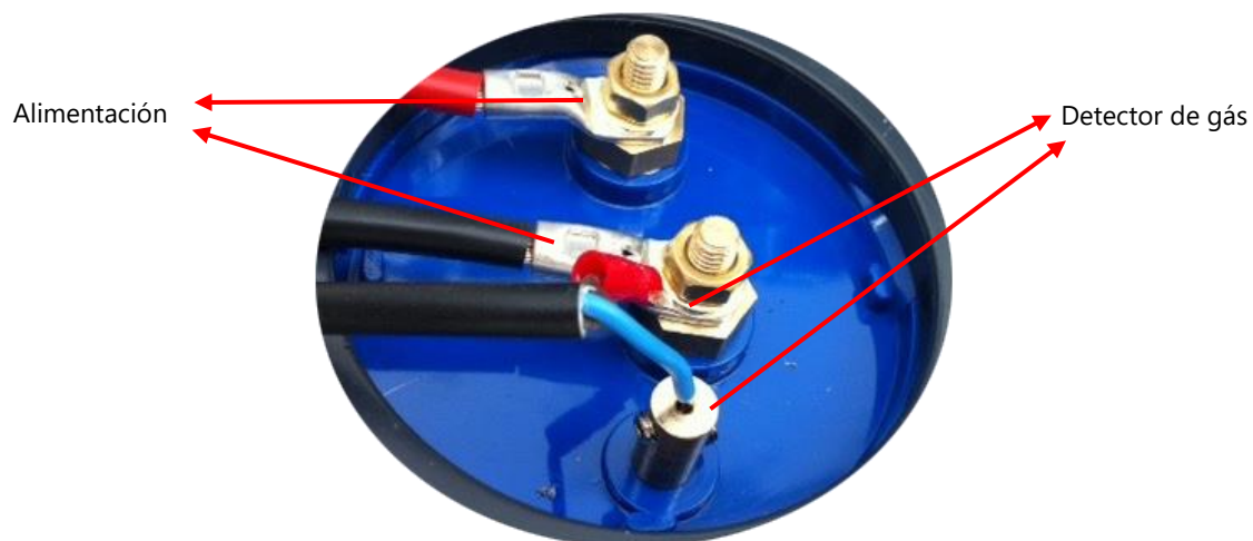
Figura 5 – Terminales de Conexión en la Celda
