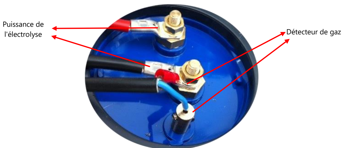
Fig 5 – Bornes de connexion de cellule d'électrolyse
