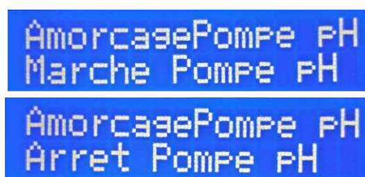
Figure 14 – Amorçage de la pompe doseuse
